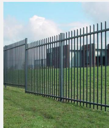
La clôture à barreaux Arena est construite d'un cadre en acier avec de barreaux carrés verticaux. La clôture respire la robustesse et la sécurité. Arena est très résistant au vandalisme et difficile à grimper. Les barreaux carrés passent à travers les lisses supérieure et inférieure et sont chanfreinés de 45° en haut. Les cadres en acier sont fixés aux poteaux avec une pièce de montage spéciale qui glisse dans les lisses supérieures et inférieures.
